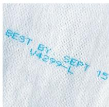
Se trata de una tinta azul de etanol que indica la humedad y que se puede lavar. Además, se hace invisible y se disuelve por completo cuando se expone al agua u a otros líquidos con base acuosa. Se utiliza principalmente como indicador de humedad visual en pañales absorbentes y productos para la incontinencia. También se puede utilizar en bandejas o contenedores de lotes cuando se requiere una eliminación muy fácil con una solución sencilla de agua.
